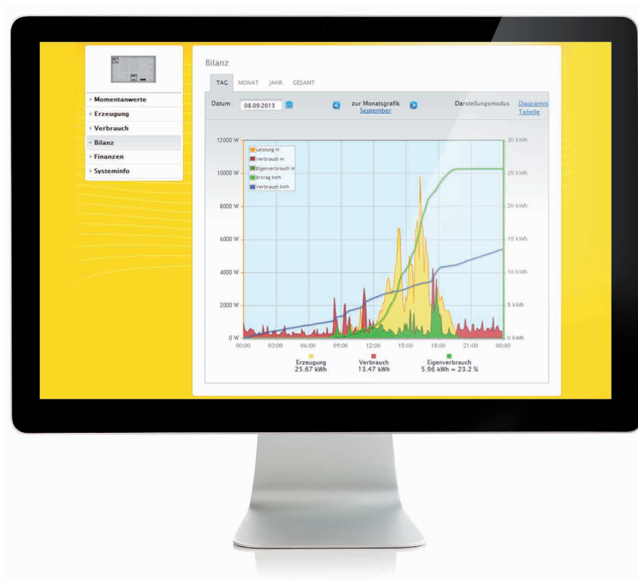
Unter „Bilanz“ wird die Erzeugung und der Verbrauch der PV-Anlage in Relation zueinander gezeigt.
